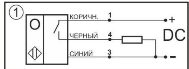
Схема соединения Нормально-разомкнутый контакт
